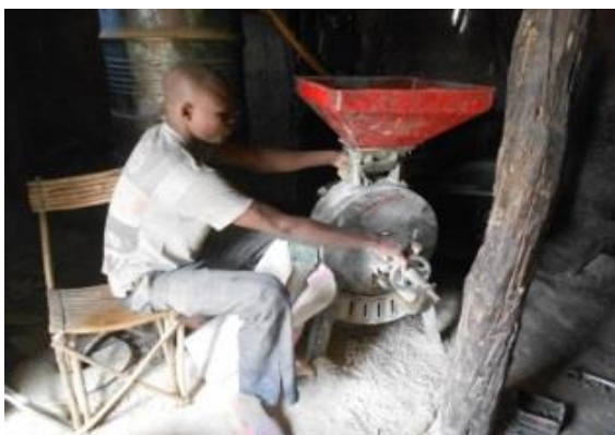
Machine fonctionnant à l'HVP de jatropha.
