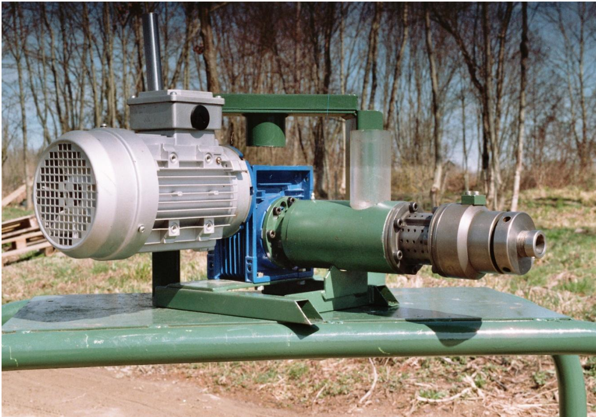
Photo ADL. Presse à tube. 15l/h
