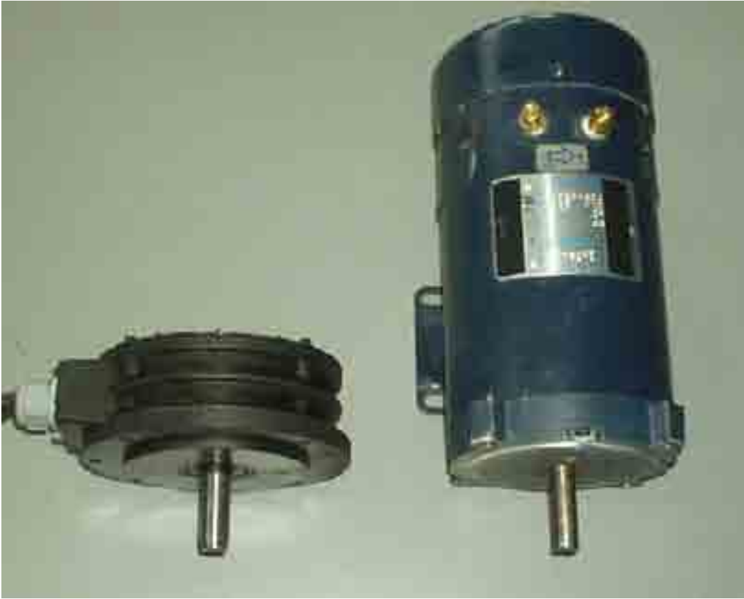
②. Moteurs radiaux et axiaux 1 à 1,5 kW ;4500tr/min
