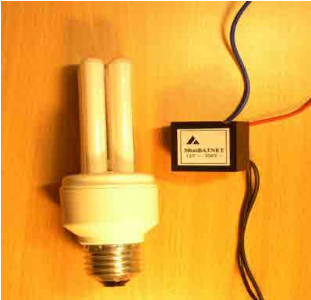
①③ . Multiplicateur Courant continu Minibatnet ( génère une tension crête correspondant à 230 Vca)
