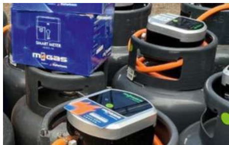
Exemples de boîtiers (smart meters) de contrôle sur les installations GPL (Circle gas au Kenya) à droite. Photo : © Circle Gas
