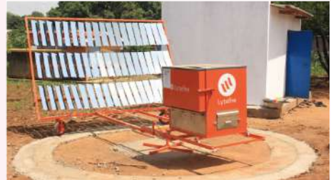
Technologie Lytefire : four solaire à concentrateur, appoint charbon de bois si besoin
