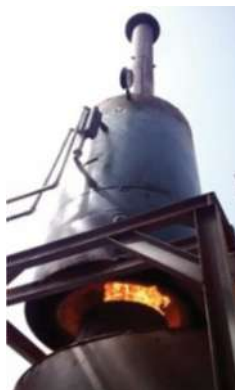
Combustion des gaz de pyrolyse
