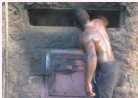
Ramonage des tubes échangeurs
