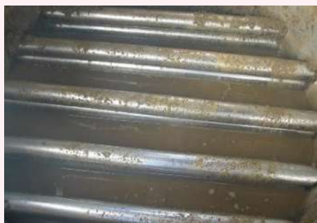
Tubes échangeurs en bas de cuve de distillation
