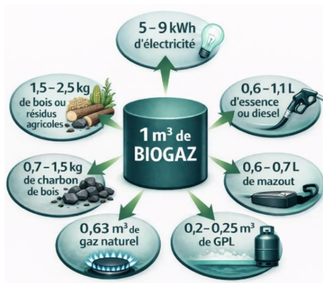
Figure 3- Equivalents énergétiques du biogaz
